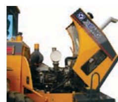
Capô de Manutenção
